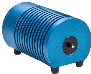
采用风扇制冷, 内部带有稳压电路, 可以提供稳定的光谱输出。光源输出光谱强度可调, 采用SMA905光纤接口, 方便通过光纤和其它设备连接, 非常适用于可见-近红外的吸收光谱和反射光谱的测量。该光源配有TTL控制的电子快门, 非常适合于系统集成。
