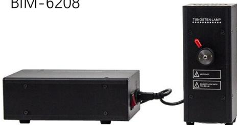
光源具有稳定的输出和弱紫外辐射等特点, 采用外置独立式电源供电, 采用灯泡可更换式结构, 20-100W不同规格的钨灯灯泡可供选择, 出光口配有可拆卸的 SMA905光纤连接器, 方便通过光纤连接光源和其他光学设备。
